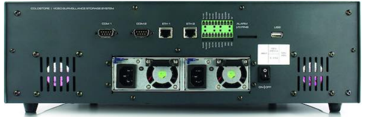
Çift Gigabit Ağ Kapısını, alarm / röle bağlantılarını ve çalışırken değiştirilebilir çift güç kaynağı seçeneğini gösteren arkadan görünüm (yukarıda). İki soğutma fanının yazılım kontrollü olduğunu ve normalde kapalı olduğunu unutmayın.
